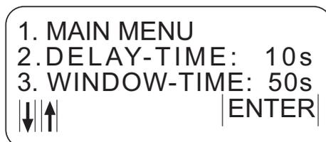
Im Menüpunkt 2 DELAY-TIME kann eine Zeitverzögerung zwischen 0 und 100 sec für die Melde-Relais eingestellt werden. Dazu wird der Cursor auf 2 gesetzt und mit ENTER das Untermenü aufgerufen.
