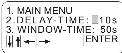
Daraufhin springt der Cursor auf die Position vor der Zeitangabe (in obiger Skizze 10s). Mit den UP- und DOWN-Tasten kann der Wert in 5er Schritten eingestellt werden. Mit ENTER wird der neue Wert übernommen, und der CURSOR wird auf die Auswahl (1,2,3) gesetzt. Auf die gleiche Art kann nun der Wert für WINDOW-TIME eingestellt werden. Hierbei ist in 10er Schritten eine Einstellung zwischen 10 und 300 s möglich.
